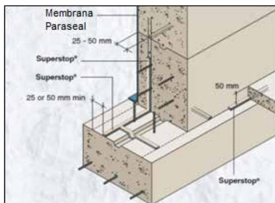
La superficie de las juntas donde se instalará **SUPERSTOP** debe ser levemente pulida con una llana. Se deben remover los residuos y limpiar la superficie antes de la instalación. Quitar el papel adhesivo. Las puntas del rollo simplemente se colocan una junto con la otra y se clavan.
